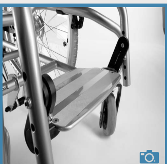
MB 20 Palette monobloc réglable en angle pour segment jambier
